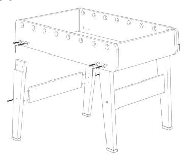
Inserire le spine in legno nelle traverse e fissare la stessa alla gamba con la vite 6x60 utilizzando la chiave a brugola da 4
