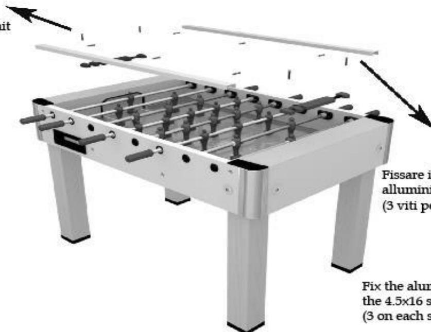
Fissare il copriboccola in alluminio con le viti 4.5x16 (3 viti per lato)
